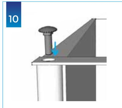
Placez la tringle sur les tubes avant de l'isoloir et insérer la vis pour la fixation.
