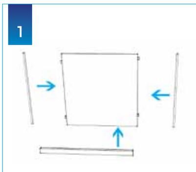
1 Sur un panneau, clipsez 2 tubes mâles et insérez une plinthe de protection sur le bas.
